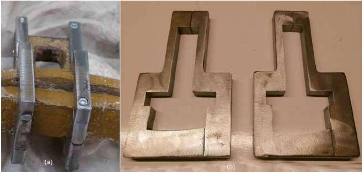
Figura 14. (a) Bridas de sujeción cáncamo/arcos situados en el aparato. Bridas antes de montar.
