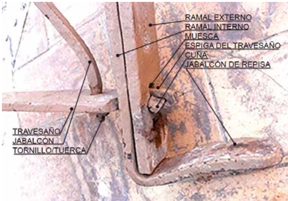
Figura 6. Muesca/ espiga/ cuña perteneciente al travesaño de cierre del aparato.
