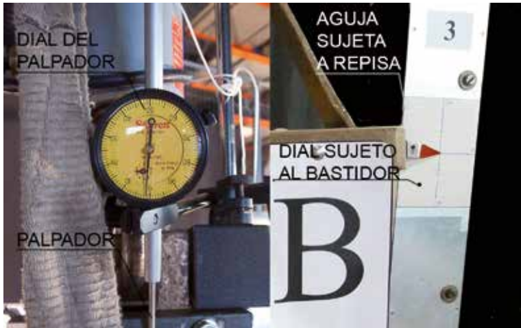
Figura 12. De izquierda a derecha: Sensor palpador aplicado al cáncamo y arco externo donde queda sujeto. Uno de los 15 monitores de deformación distribuidos por el aparato.
