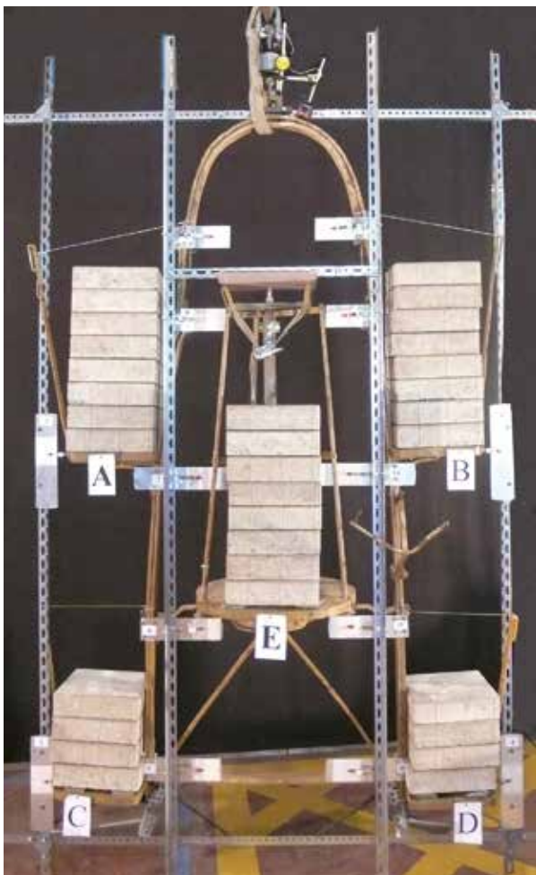
Figura 13. Aparato sometido a la máxima carga de ensayo.
