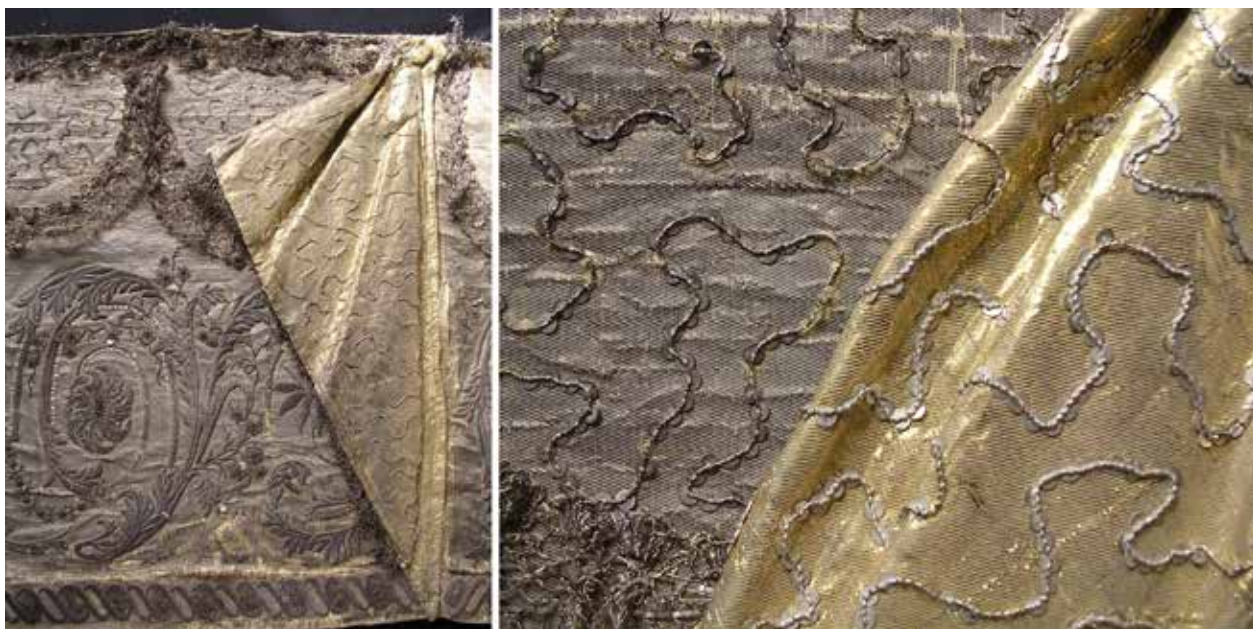
Fig. 25. Diferencia del grado de corrosión y deterioro de los elementos de plata y plata dorada.
