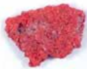
Fig. 8. Pequeña partícula del pigmento rojo identificado como cinabrio. (Microscopio óptico, X 10,7). / M. Pilar de Luxán.
