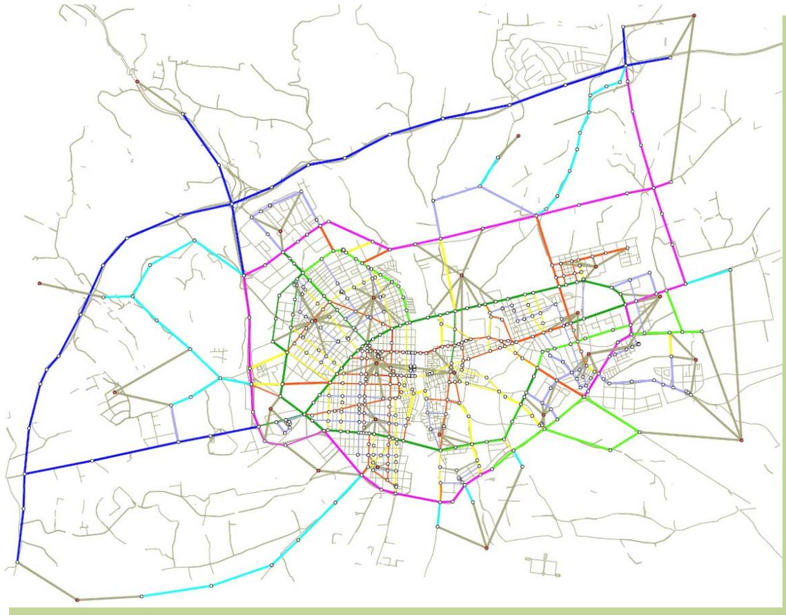
Ilustración 1. Red viaria modelizada representada por tipo de arco
