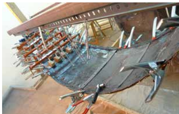
FIGURA 35. El mismo equipo empleado para conformar las alas fue empleado para prensar el tejido original del ala al composite durante la adhesión entre ambos.
