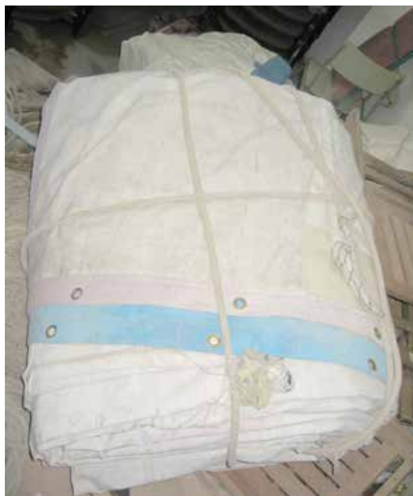
FIGURA 12. Modo en que se guardaba el lienzo del cielo. El doblado con ángulo agudo genera tensiones que pueden superar la resistencia del material, provocando fracturas.
