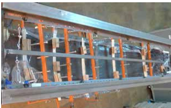
FIGURA 34. Parte del equipo artesanal utilizado para dar forma a cada ala.
