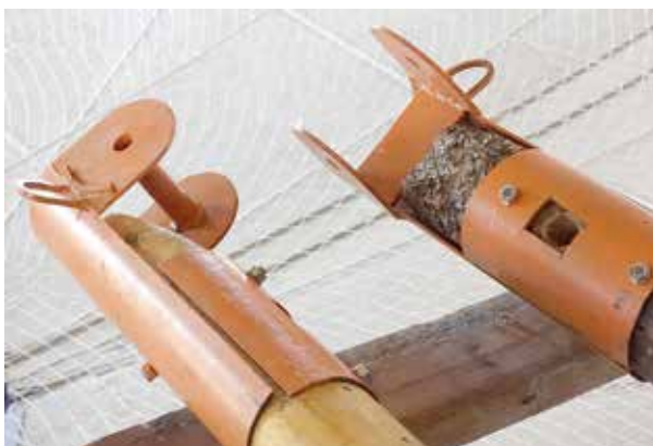
FIGURA 26. Articulación diseñada específicamente para formar el vértice de la cabria. Permite modificar el montaje y resolver las limitaciones del sistema anterior.
