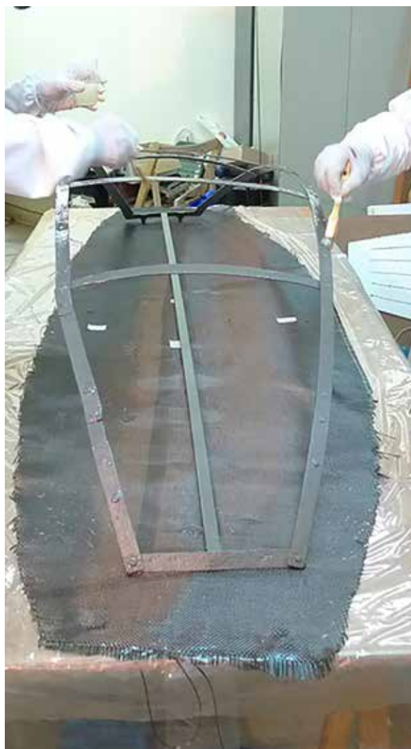
FIGURA 33. Impregnación del tejido de fibra de carbono y del bastidor con resina epoxi.
