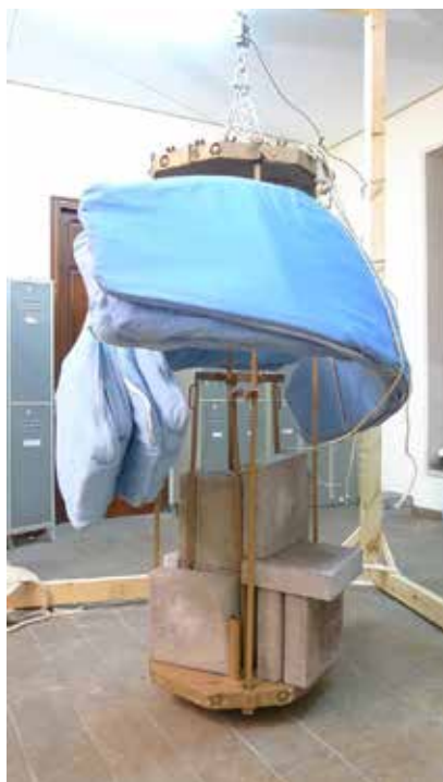
FIGURA 38. Ensayo de carga realizado tras finalizar con un peso de 210 kgf (210 daN).
